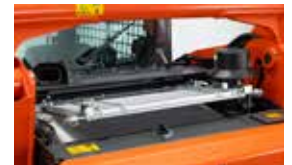
Radiateur monté en position supérieure et refroidisseur d'huile
